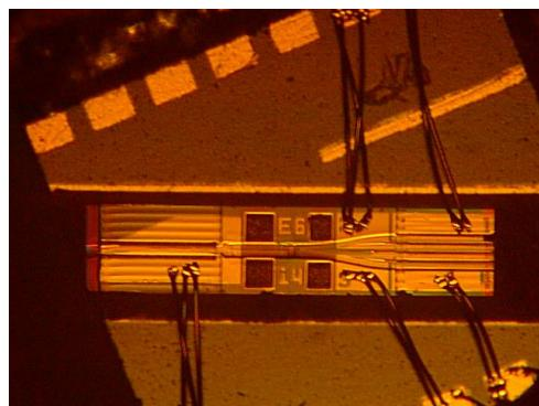
**Figuur 1:** Foto van de component gebruikt in de metingen van de werking van de SOA en DFB laser diode combinatie. Van links naar rechts kunnen de SOA, de MMI-koppelaar en de DFB laser diode onderscheiden worden.
