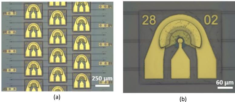
**Figuur. 6** Microscopieafbeelding van (a) een set van volledig gefabriceerde Gen2-VCSILs en (b) van een enkele Gen2-VCSIL, waarbij de SiN-golfgeleiders zichtbaar zijn op de chip.
