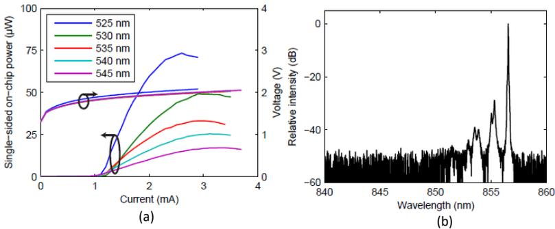
**Figuur.7** (a) Golfgeleidergekoppelde licht-spanning-stroom karakteristiek voor 5  $\mu\text{m}$  oxide apertuur diameter VCSILs met een wisselende intracaviteit diffractie-koppelaarperiode van 525 – 545 nm (na goud depositie op het bovenste spiegeloppervlak). (b) Spectrum voor de 525nm VCSIL, bij 2.5 mA.
