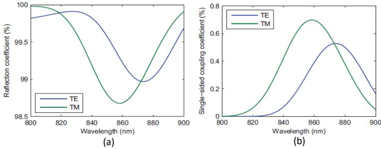
**Figuur. 5** (a) De gesimuleerde reflectiecoëfficiënt en (b) de enkelvoudige koppelingsefficiëntie van de diffractiekoppelaar plus diëlektrische spiegel in functie van de golflengte voor TE en TM polarisaties. (koppelaarperiode = 530 nm, DC = 50%).
